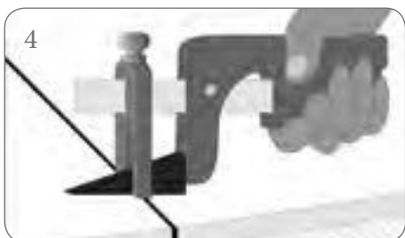
4 Apretar con el alicate especial. Grip with the ceramic pliers. Presser avec la pince spécial. Nivellierzange einsetzen. Стягивание специальными плоскогубцами.
