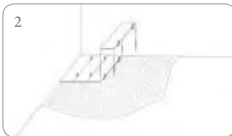
2 Colocación piezas cerámicas con los calzadores en las juntas. Installation of the pieces with the wedges at the edges. Pose des pièces avec les croisillons dans les joints. Verlegen der Fliesen mit Zuglaschen (Verlegehilfen zum Nivellieren). Установка пластмассовых застёжек в швы.
