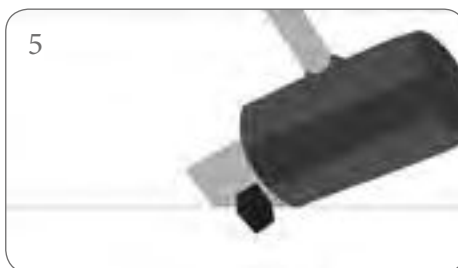
5 Una vez secado el cemento cola, golpear con una maza de goma lateralmente para romper el calzador. Once the adhesive has dried strike with the rubber mallet to break the cover wedges. Une fois le ciment colle séché, taper avec un maillet en caoutchouc sur le côté pour casser le croisillons. Sobald der Kleber getrocknet ist, wird seitlich mit einem Gummihammer gegen die Zuglaschen geschlagen um sie an der Sollbruchstelle raus zu brechen. После того как клей высох, ударить вдоль шва резиновой киянкой для обломки пластмассовой застёжки
